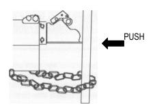
FIG. 2 - TESTING SURGE BRAKE
